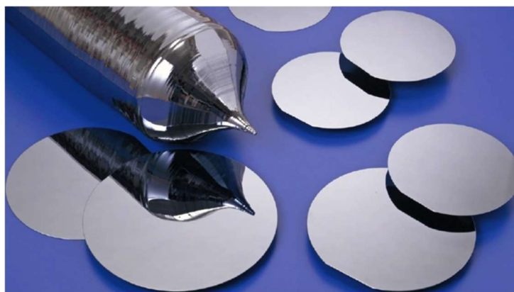
図 1.1 Si 単結晶インゴットと Si ウェーハ[13]
