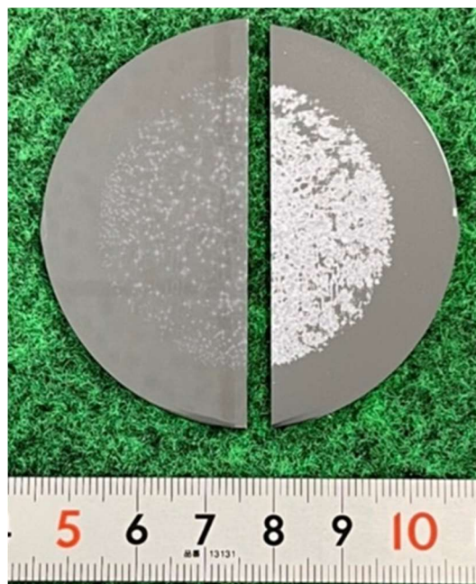
図 6.5 結晶長 97mm におけるインゴットの水平断面 ( \{100\} 面) 上の写真 (右半分：非選択エッチングのみ，左半分：研磨後選択エッチング)
