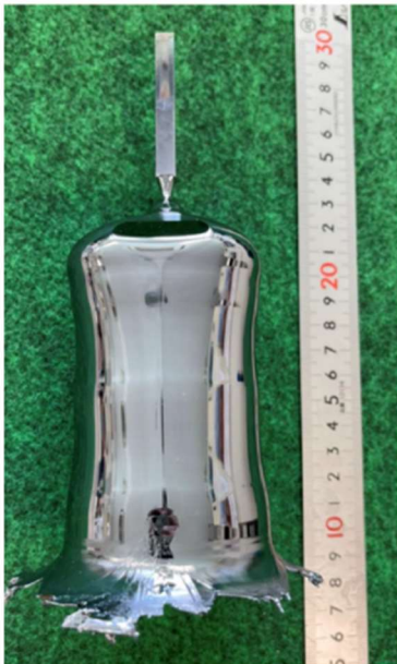
図 6.2 取り出した(a) Si 単結晶の写真, (b)Si 結晶断面模式図とサイズ
