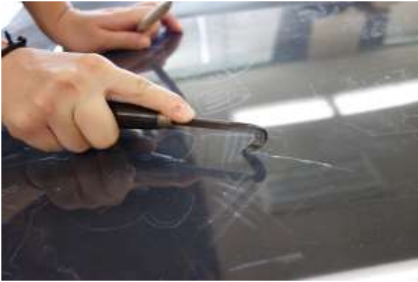
図 6：金属板カッターによる塩ビ板への描画
